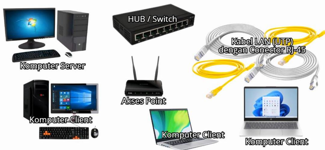
Gambar 371 : Gambar perangkat yang diperlukan untuk membangun LAN
