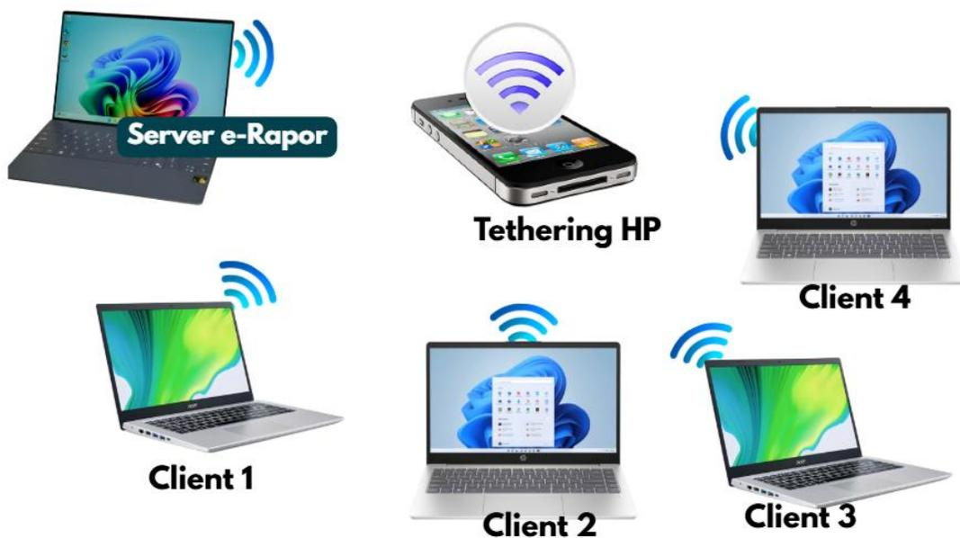
Gambar 389 : Perangkat untuk membangun jaringan dengan *wifi*
